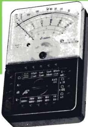
Strumento che unisce alla massima semplicità d'uso un minimo ingombro. Realizzato completamente su circuito stampato. Assenza totale di commutatori rotanti e quindi falsi contatti dovuti all'usura. Jack di contatto di concezione completamente nuova. Munito di dispositivo di protezione.
